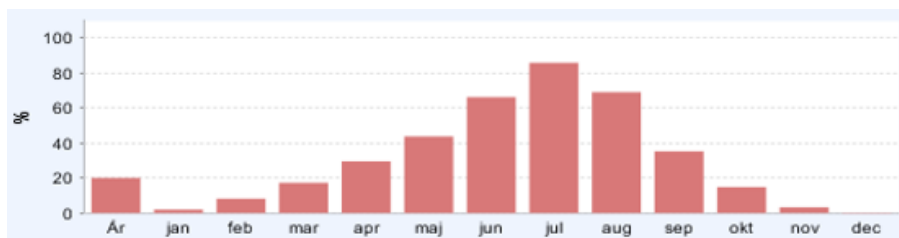
Figur 30 Andelen solvärme av det totala värmebehovet enligt simuleringar för Umeå.
