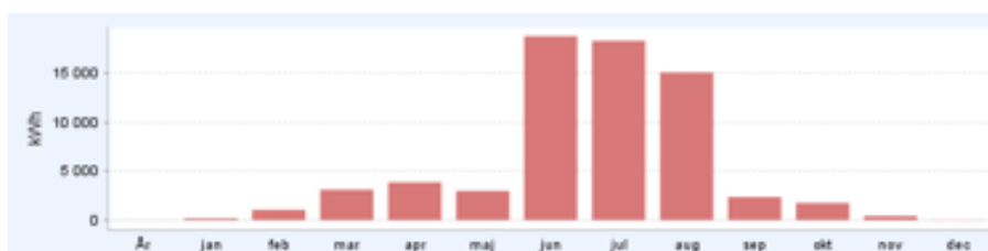
Figur 36 Solvärme till anläggningen per månad för alternativet med fjärrvärmeutgången och temperaturgivaren på 65 % höjd av tankens totala höjd.
